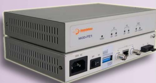
MOD-FE1, 采用专用集成电路研制的高性能E1 光纤调制解调器, 它将一个成帧或非成帧的E1数据信号直接调制到单模或多模光纤上, 送入光缆线路传输。在光缆的另一端, 光信号被解调成成帧或非成帧的E1数据信号。E1口可直接接图像、数据终端的E1口或复用器、交换机、路由器的WAN端口, 可组成专网或进行广域网连接
